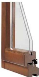
Le finestre e le porte finestre ad una o più ante saranno realizzate con telai in legno di Pino di Svezia mordenzato, dello spessore nominale di mm. 55, con vetri ad intercapedine 4/12/6 per garantire, oltre all'isolamento termico, anche una buona coibenza acustica, completi di maniglia in cromo satinata tipo Ridanna o similare, e di zanzariera a scomparsa.
