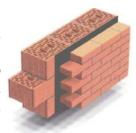
Le murature portanti di separazione, verranno realizzate in doppia muratura portante da cm. 20+20 di spessore, con interposto una intercapedine coibentata con materiale idoneo a scelta della D.L. al fine di ridurre la trasmissione del rumore tra le unità immobiliari attigue.
