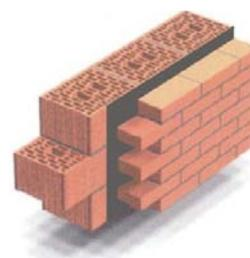
Le murature portanti interne di separazione, verranno realizzate in muratura portante eseguita con blocchi cassero sp. cm. 30 gettati con calcestruzzo armato, al fine di ridurre anche la trasmissione del rumore tra le unità immobiliari attigue.
