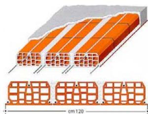
I solai saranno in laterizio e c.a. da intonacare, di opportuna altezza ed atti a garantire un sovraccarico accidentale utile di  $2000 \text{ N/m}^2$  per i piani d'abitazione e di  $1500 \text{ N/m}^2$  per il solaio di copertura, realizzato a più falde con solaio in legno lamellare completo di pacchetto ventilato ed isolato.
